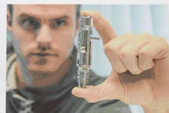
Neben einer fundierten Verfahrensrichtlinie enthält der durch das Clean-Med-Netzwerk erstellte Leitfaden auch Prüfkörper, anhand derer kleine und mittlere Unternehmen die eigenen Reinigungsprozesse überprüfen können. Foto: Privat
